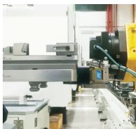
机械手配合联轴轴实现快速抓取案例
